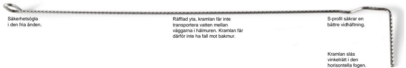
Bild 1. Patenterad Blockkramla, räfflad, rivfri, med S-profil.
